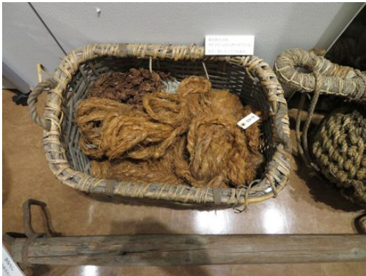
写真5. オヒョウの繊維を用いた船のアカ止め (籠の中). (道の駅(厚田)の展示, 2020年, 石橋孝夫氏撮影).
