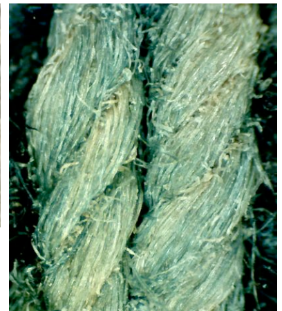
図11. 刺繍部分で綿糸が使用されている部分（顕微鏡観察）。
