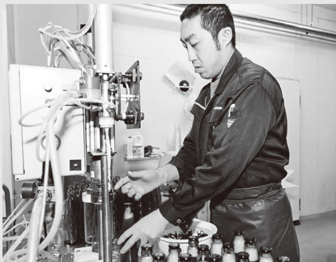
▲「Gold Cherry」は麦汁の生成→サクランボ投入→主発酵(約10日)→二次発酵(約2カ月)→ろ過を経て瓶詰めします(写真)。
