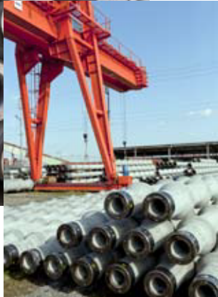
▲ホッコングループの一つ、ホッコンJP(株)では、マンションなどの高層建築物の基礎となるコンクリート製のパイル(杭)が製造されています。
