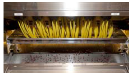
▲③ 豆の色を波形グラフに変換。その形により豆を選別します。
