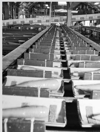
▲ニンジンは重さ別に2L、L、M、Sの4種類に分けられます。写真は重量選別機。
