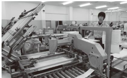
◀印刷された紙を折る機械(写真右)と、とじと裁断を行う製本機(写真左)。なお、アイワードでは障がい者雇用にも力を入れていて、製本工程では聴覚障がいのある方が20人活躍しています。
