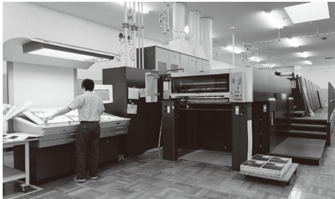
▲工場には枚葉印刷機が全部で10台あり、写真はそのうちでも片面8色、または4色×4色の両面印刷ができるドイツ製の最新鋭タイプ。
