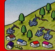
斜面から水がふき出す
