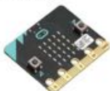
micro:bitの本体(基板)。USBケーブルでパソコンと接続し、プログラムを転送する。
