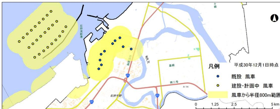
図 14 稼働中及び建設・計画中の風力発電設備からの離隔距離 (一部抜粋)
