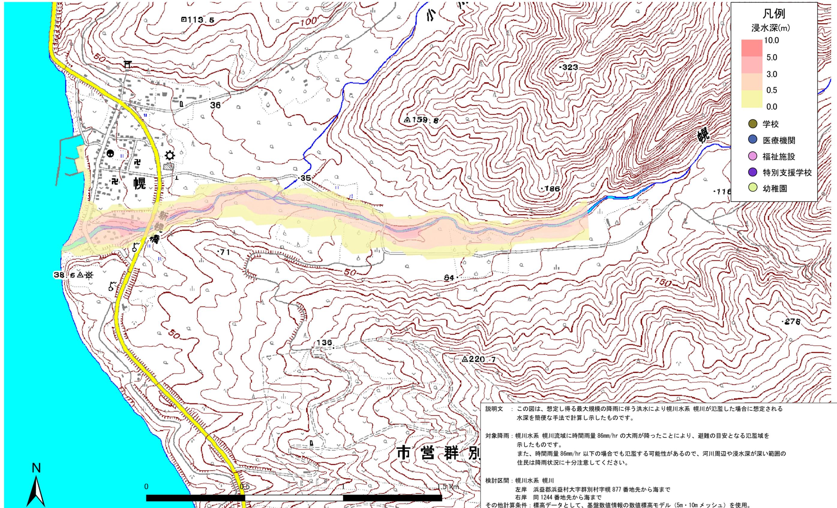
説明文 : この図は、想定し得る最大規模の降雨に伴う洪水により幌川水系 幌川が氾濫した場合に想定される水深を簡便な手法で計算し示したものです。
