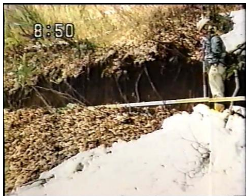
斜面のひびが進行してできた段差
