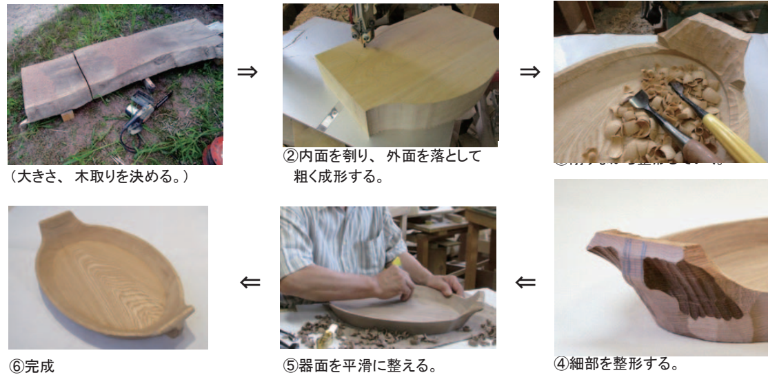
図2-1. 舟形浅鉢容器 (No.96580) をモデルとした現代の技術による復元製作の工程。
