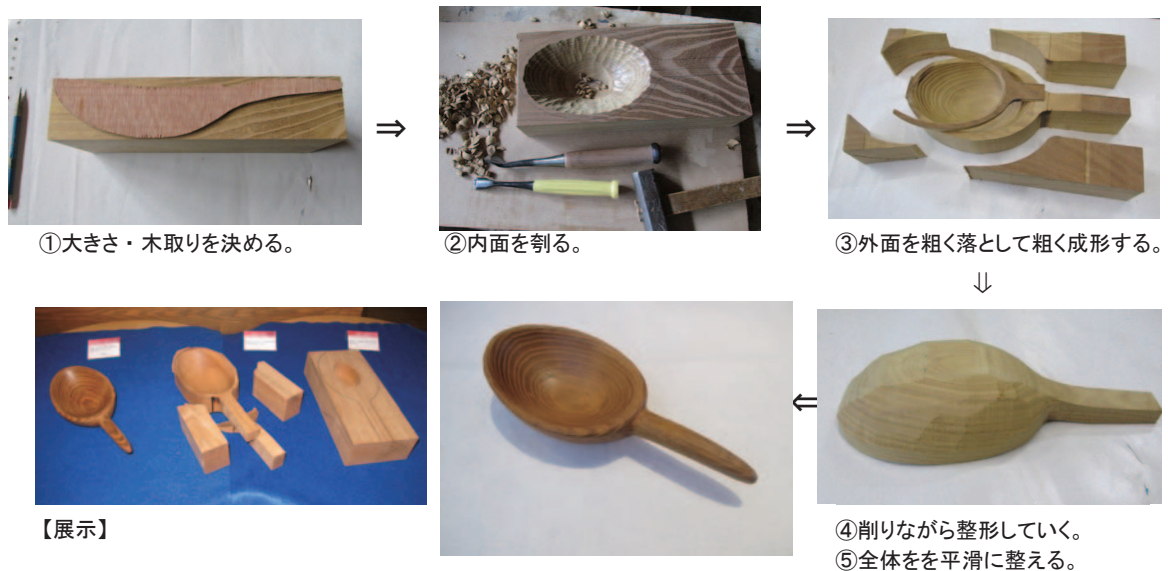
図2-2. スプーン形柄付容器 (No.96925) をモデルとした現代の技術による復元製作の工程。 (写真撮影協力：片岡祥光氏)
