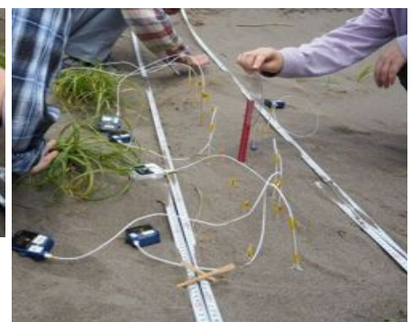
3. 温度(地表面から1cm深)の測定. 傾斜角度を測定した位置に温度センサを差入れ測定. 繰返ししながら上がっていく.
