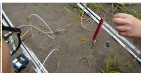
2. 傾斜角度の測定. 傾斜に対して測定器を垂直に立てて、おもりで吊った糸の角度を読む.
