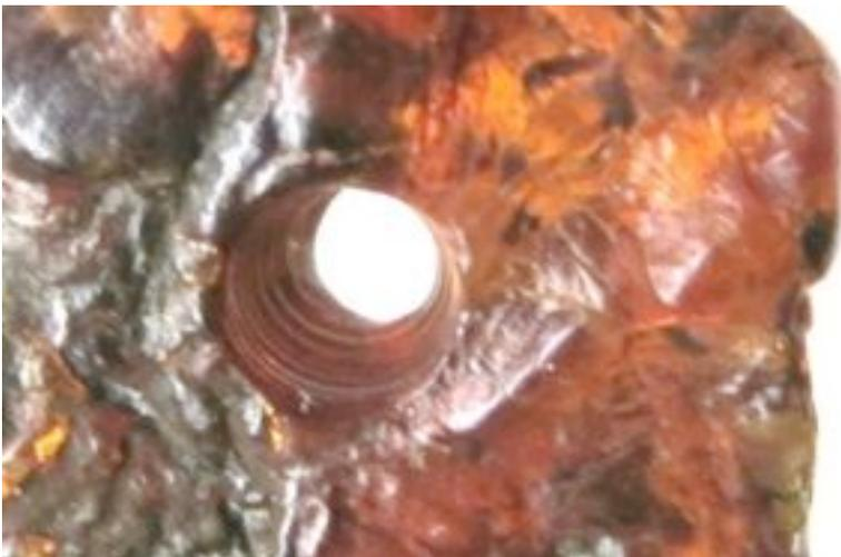
図10. 穴の内壁の傷痕 (開口部で径 4 mm) .
