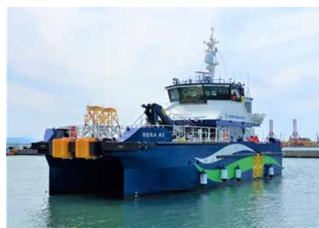
▲作業員が洋上風力発電機への移動に使う専用船「CTV(Crew Transfer Vessel)」
