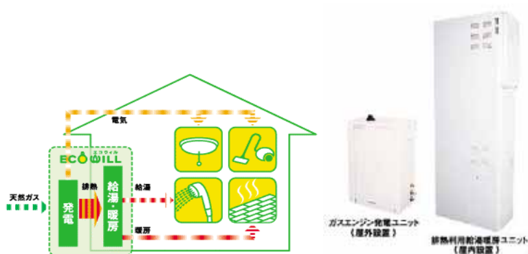
図 2.9 家庭用天然ガスコージェネレーションシステム < 出所 > 北海道ガス(株)ホームページ
