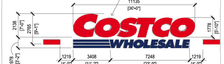
A3 BUILDING SIGNAGE SCALE: 1:100
