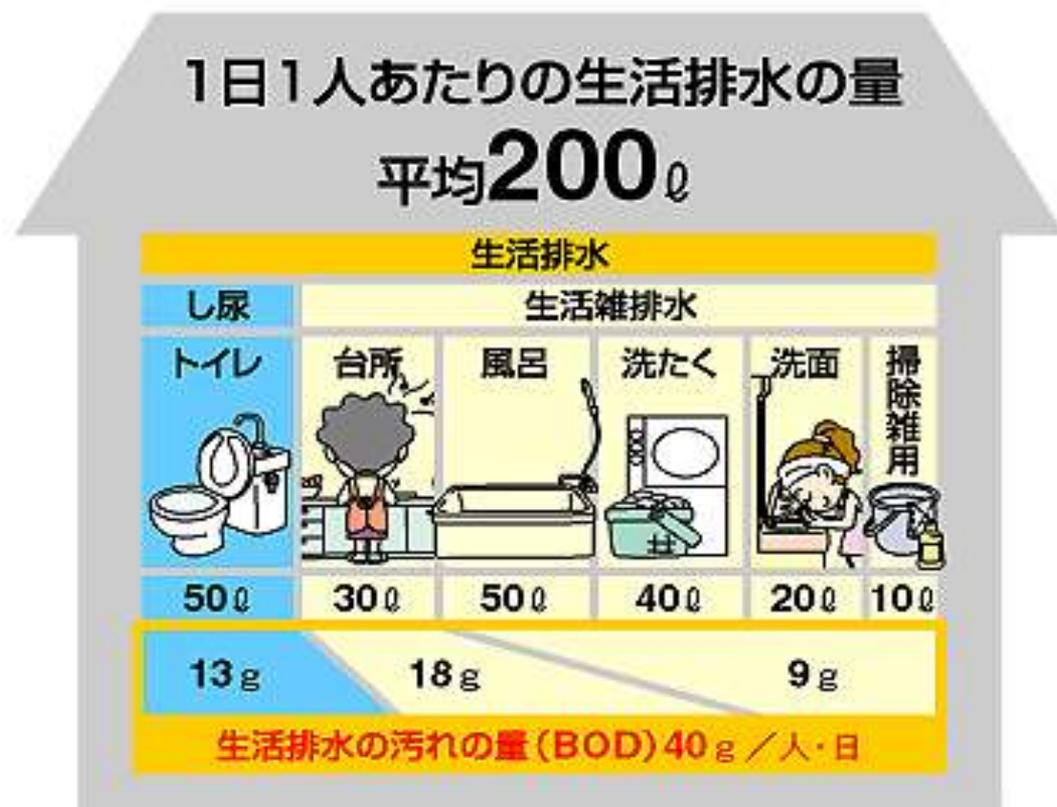
汚れの量40グラム/人/日なので、1日の排水量200リットルで割ると、 $40\text{グラム} \div 200\text{リットル} = 0.200\text{グラム/リットル}$ (**200mg/L**)となります。
